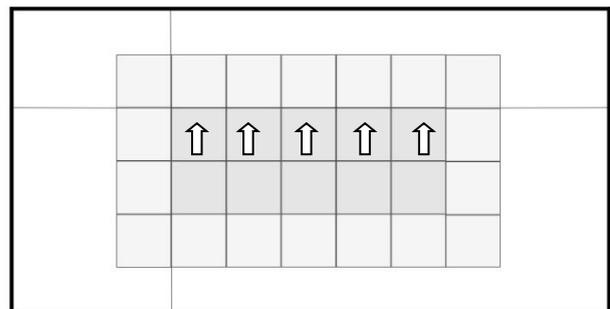
Zum Beginn der Verlegung verbinden Sie 2 x 5 Platten mit der Verzahnung und richten den Verbund in der Raummitte parallel zum Grundriss aus. Prüfen Sie jetzt die Maße zu den Wänden nach allen Seiten und verschieben den Plattenverbund so, dass zur Wand hin mit möglichst großen Plattenstücken gearbeitet werden kann (Nutzmaß der Platten 0,95 x 0,95 m). Beachten Sie hierbei auch Säulen, Wandvorsprünge, Tür- und Heizungsrisen.
