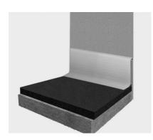
Stellen Sie evtl. Toleranzen in jeder Plattenreihe sofort durch Anlegen eines Richtscheits oder einer Schlagschnur fest und gleich diese durch Korrektur der Platten aus.
