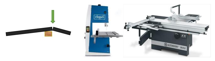
Bei größeren Mengen oder speziellen Zuschnitten kann die Bearbeitung auf einer Band- oder Formatkreissäge erfolgen.
