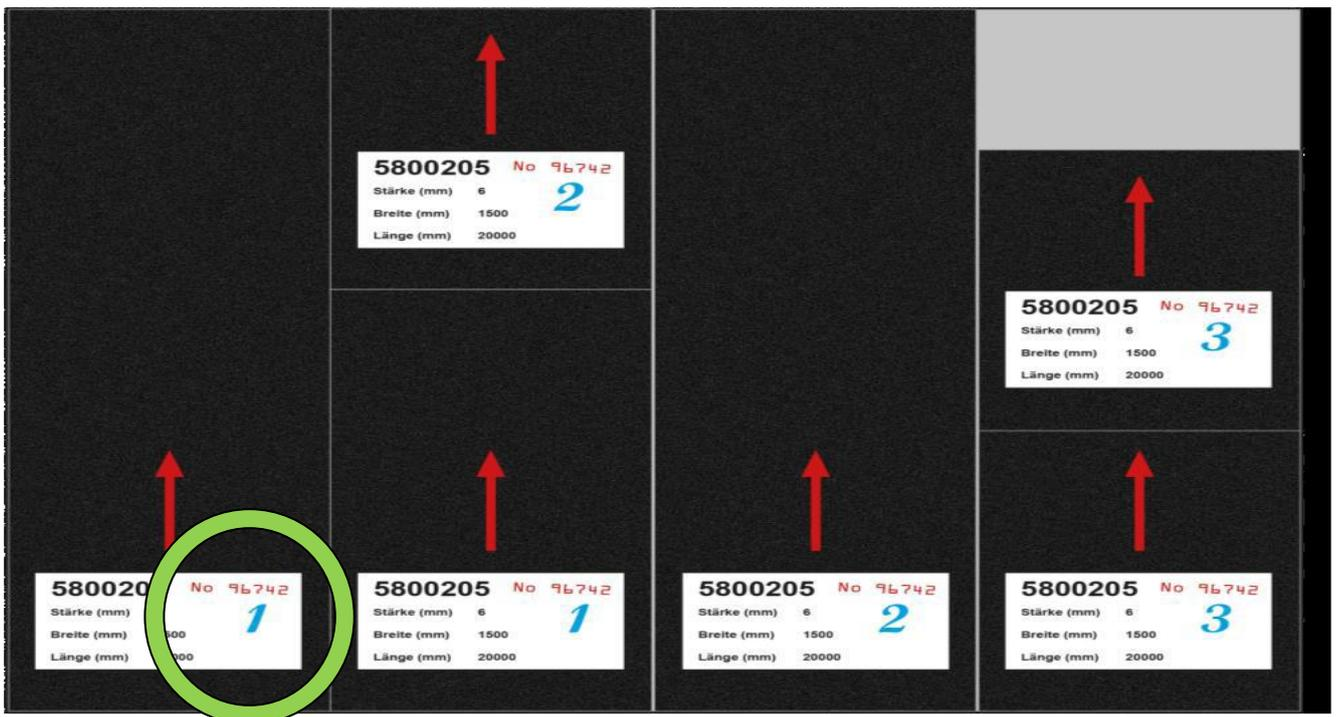
Verwenden Sie chargengleiche Rollen und verlegen diese fortlaufend nach der Rollenummer.
