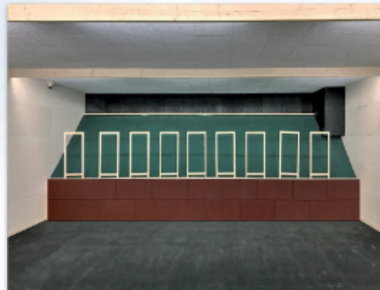
Rückprallschutz am Geschossfangansatz
